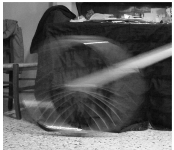
Figura 11. Fotografia di una ruota che rotola. La sorgente è una lampada a bagliore.
