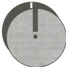
Fig. 40.4. Il disco anteriore è fermo, quello posteriore è solidale con l'asse del motorino.
