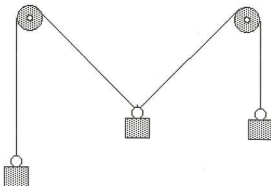
Fig. 26.1. Un filo, teso da due pesi uguali, passa attraverso due carrucole fisse
