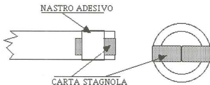
Fig. 59.2. La bocca del fucile con l'interruttore di stagnola.
