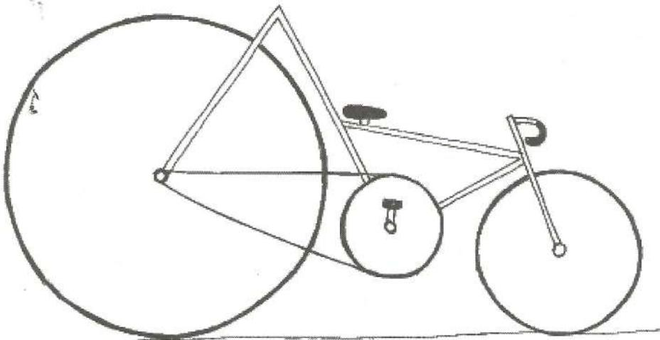
Fig.2.4. Modello di bicicletta per alte velocità. Deve avere un rapporto alto e un grande raggio della ruota motrice.
