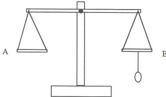
Fig. 15.3. Uso della bilancia idrostatica per la misura del volume di UN uovo.
