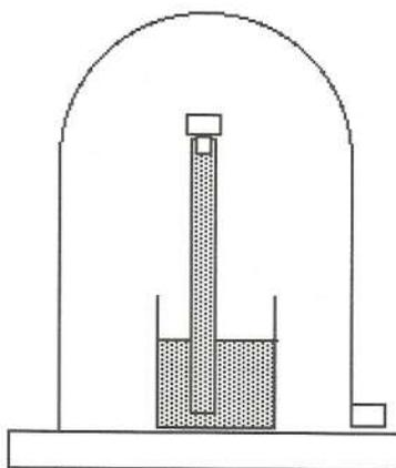
Fig. I.2. Un tubo di vetro, chiuso ad un'estremo, contenente acqua colorata, ha l'estremità aperta immersa nello stesso liquido. Il tutto è contenuto in una campana di vetro a tenuta. Estrahendo l'aria con una pompa, si osserva che il tubo si svuota ( e l'acqua si mette a bollire).
