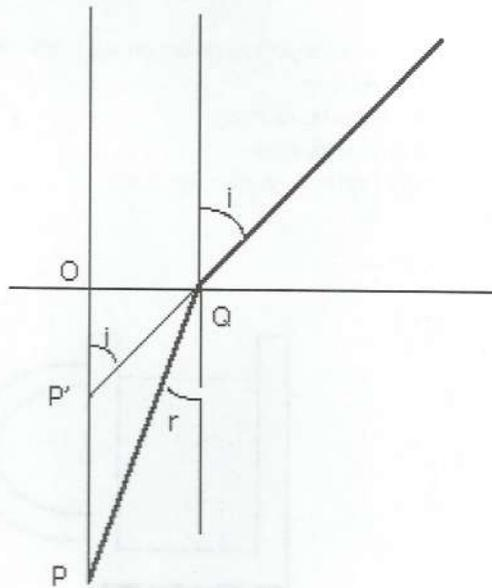
Fig. 10.2. La rifrazione di un raggio che forma un angolo piccolo rispetto alla verticale.  $OP$  è la profondità vera, che indichiamo con  $P$  ed  $OP'$  la profondità apparente  $p$ .
