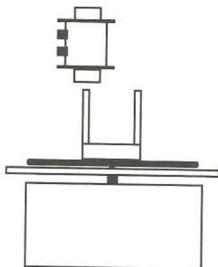
Fig. 9.1. Sul piatto del giradischi è appoggiato un magnete che induce un impulso di corrente nella bobina fissata al di sopra.
