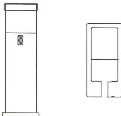
Fig. 16.1. Cilindro di vetro quasi pieno d'acqua in cui flotta il diavoletto e la sua struttura interna (camera d'aria).
