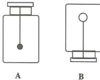
Fig.5.1. Il coperchio del vasetto A sostiene una pallina di vetro appesa mediante un filo; quello del vasetto B trattiene una pallina leggera che flotta nel liquido.
