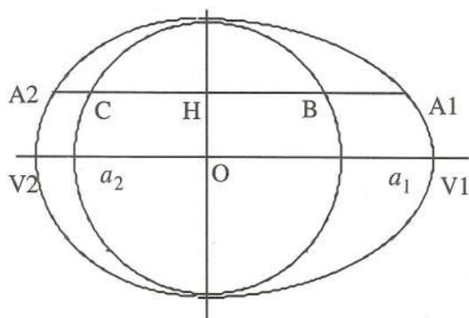
Fig. 15.2. Il profilo dell'uovo si può ritenere ottenuto da un cerchio deformato in misura diversa lungo l'asse maggiore di simmetria.
