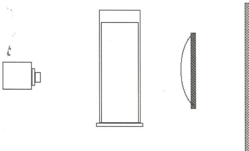
Fig.13.1. Disposizione sperimentale: la lente produce un'immagine ingrandita del cilindro illuminato dal proiettore.
