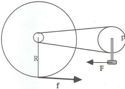
Fig.2.9. Le forze agenti sul pedale e sul bordo della ruota.
