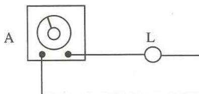
Fig.14.1. Una lampadina alimentata con un generatore a f.e.m. variabile.
