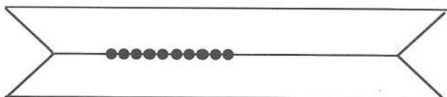
Fig.12.2. Come misurare il diametro medio di un pallino con una striscia di carta millimetrata.
