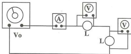
Fig. 14.3. Come misurare la corrente e la tensione su ciascuna lampada.
