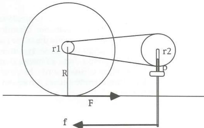
Fig. 2.10. La forza è applicata all'estremità di un bastone fissato al pedale.
