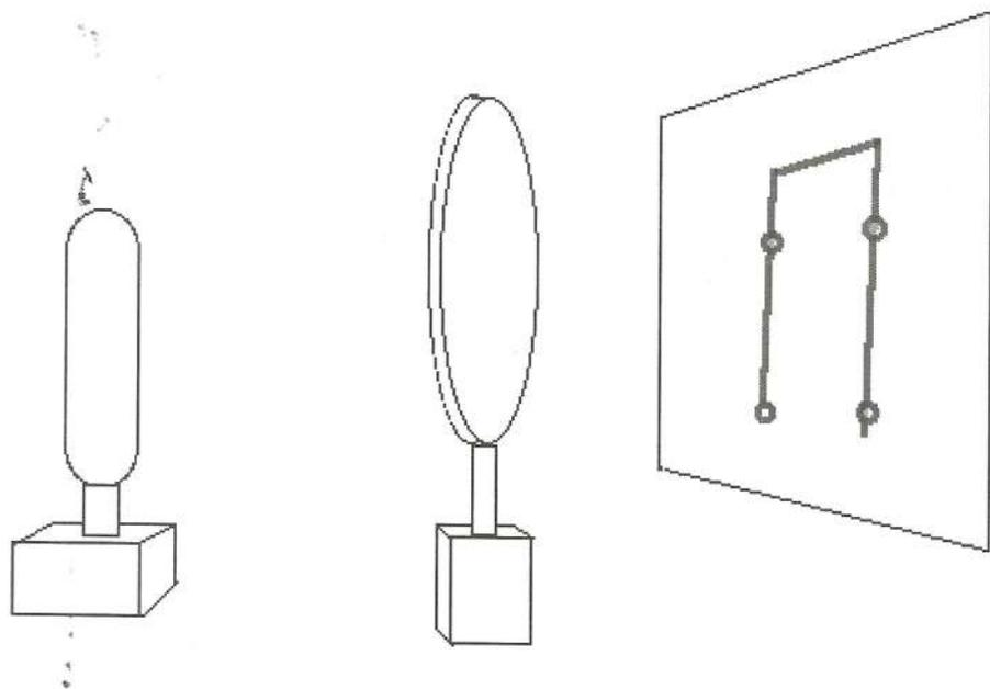
FIG.8.1. L'immagine del filamento della lampada viene messa a fuoco mediante una lente convergente.
