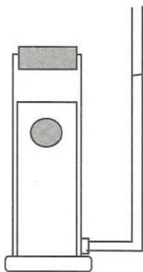
Fig. 16.2. Come aumentare la pressione all'interno del cilindro.
