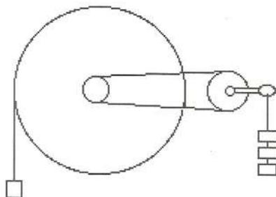
Fig.2.5. Equilibrio delle forze applicate al pedale ed al bordo della ruota.
