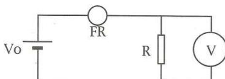
Fig. 1.2. Schema di fotometro.  $V_0$ = batteria 9V; FR= fotoresistenza, R= resistore 1 k $\Omega$ , 1/4 W, V= voltmetro.
