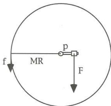
Fig.2.6. Equilibrio delle forze applicate al pedale e al bordo della ruota virtuale (di raggio  $MR$ ).
