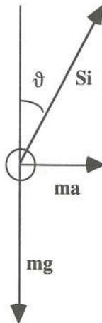
Fig.5.6. Forze agenti sulla pallina d'acqua nel sistema di riferimento del laboratorio.
