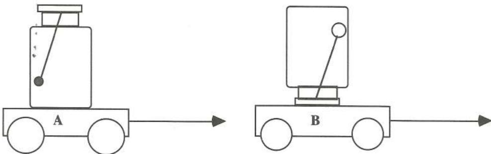
Fig. 5.2. I vasetti in fase di accelerazione.
