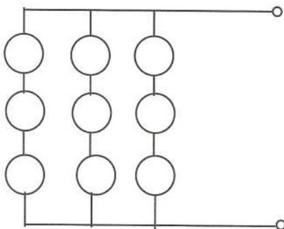
Fig. 1.3. La parte fotosensibile del fotometro è costituita da una disposizione di fotoresistenze.
