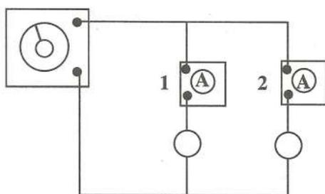
Fig. 14.4. Due amperometri consentono di misurare la corrente che fluisce in ogni lampada.
