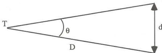
Fig. 17.1. Il diametro angolare del Sole. T=Terra; d= diametro del Sole, D= distanza Terra-Sole,  $\theta$ = diametro angolare del Sole.
