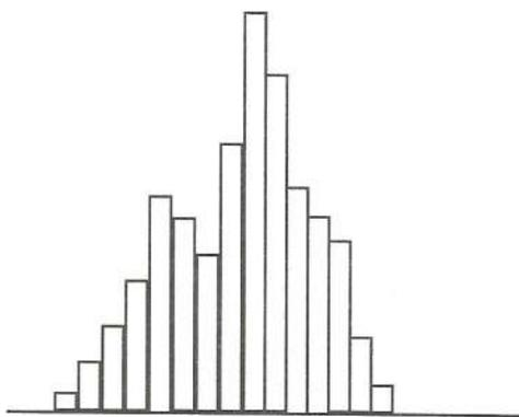
Fig.11.2. Distribuzione delle misure ottenute da una scatola di chiodini di due diversi tipi.
