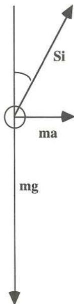
Fig. 5.7. Forze agenti sulla pallina di vetro nel sistema di riferimento del laboratorio.
