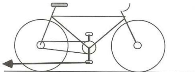
Fig.2.8. Alla bicicletta, appoggiata al suolo, è applicata una forza nel verso della freccia, tramite uno spago legato al pedale.
