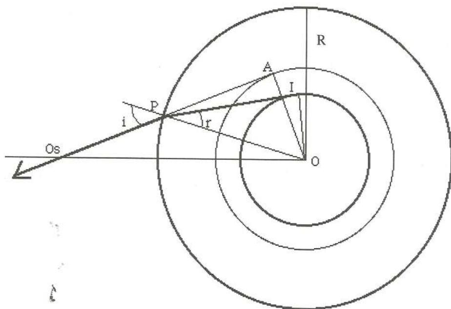
Fig. 10.4. Raggio interno reale e raggio apparente del cilindro determinato dalla rifrazione della luce.
