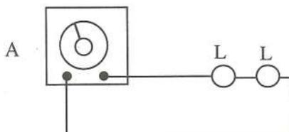
Fig. 14.2. Con la stessa f.e.m. si alimentano due lampade in serie.
