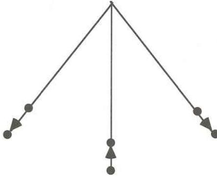
Fig.4.2. Alle estremità dell'oscillazione il pendolo si allunga, nella parte centrale, si accorcia.
